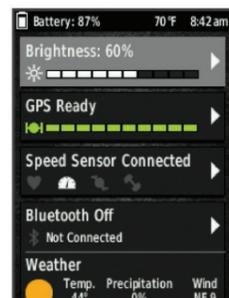
На экране появится страница состояния. Немигающий значок означает, что сигнал найден или датчик подключен.
