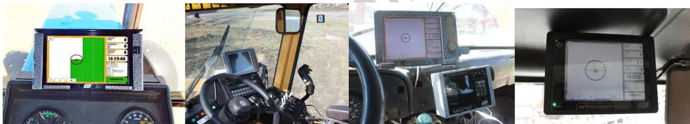
Настройки максимально понятны. Включают самые необходимые опции (установка ширины захвата, Контроль количества и качества приема спутников, установка контроля максимальной скорости обработки с последующей индикацией, установка часового пояса по регионам, просмотр качества обработанных полей).
