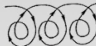
Для сварки толстостенных конструкций с гарантированным проплавлением корневого участка шва.
