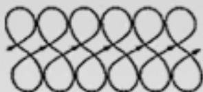
Для усиленного прогрева кромок шва, особенно при сварке высоколегированных сталей. Электрод задерживают на краях, чтобы не было прожога или вытекания металла при сварке вертикальных швов.
