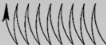
Для стыковых швов со скосом кромок и для угловых швов с катетом менее 6 мм, выполняемых в любом положении электродами диаметром до 4 мм.
