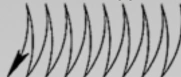
Для сварки в нижнем положении, а также для вертикальных и потолочных швов с выпуклой наружной поверхностью.
