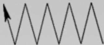
Применяют для получения наплавленных валиков при сварке встык без скоса кромок в нижнем положении и если нет вероятности прожечь деталь.
