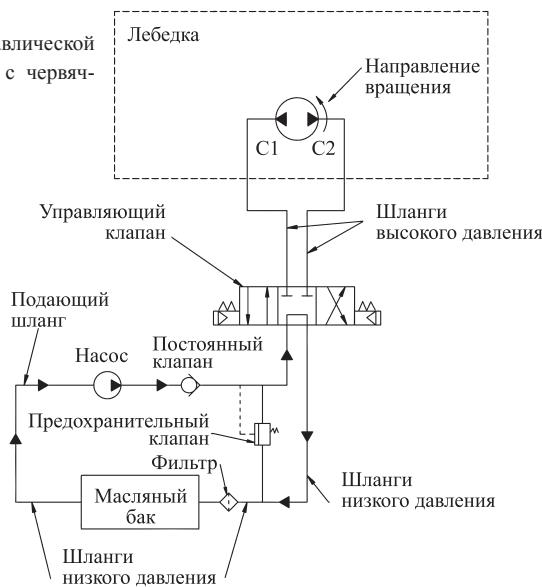
Схема подключения гидравлических лебедок «Буйвол» ЛПГ45И, ЛПГ55И, ЛПГ68И, ЛПГ81И с планетарными редукторами.
