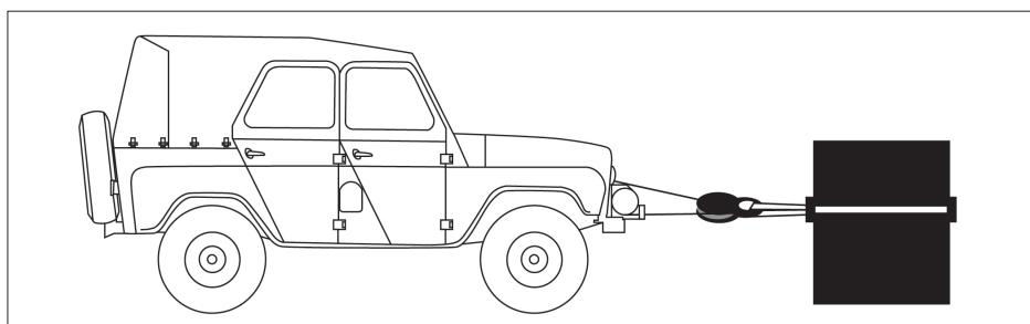
Не допускайте перегрева двигателя лебедки. Если двигатель лебедки становится горячим на ощупь, дайте ему остыть в течении нескольких минут.
