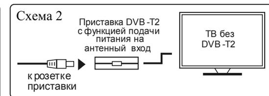
Для антенн моделей Эфир-08AF и Эфир-08 AF TURBO после подключения кабеля к телевизору или цифровой приставке (схемы подключения аналогичны схемам 1 и 2), следует включить подачу питания +5В на цифровую антенну от телевизора или цифровой приставки. Подача питания +5В включается согласно руководству по эксплуатации телевизора или цифровой приставки DVB-T2.
