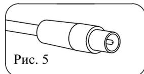
Для телевизионной вилки разделка кабеля зависит от конкретной конструкции приобретённой вилки и в руководстве не приводится.
