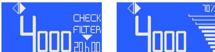
При перезагрузке аппарата ранее установленные настройки отобразятся на дисплее (например, направление и скорость вращения, мощность всасывания и т.д.)
