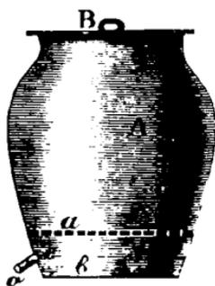
Рис. 16-й. Одна изъ глиняныхъ корчагъ, употребляемыхъ въ квасоварнѣ *Загребина* для запеканія тѣста и для приготовления изъ него сусла.
