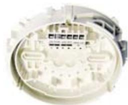
Основание изготовлено из экологически чистых материалов, устойчивых к ударам и царапинам. Резиновая прокладка защищает от протечек, грязи и попадания капель воды сверху. Для упрощения установки основание снабжено клеммами без винтов. Предусмотрено место для дополнительных контактных разъемов, таких как микроразъемы 0,5 мм<sup>2</sup> и разъемы 2,5 мм<sup>2</sup>. Подходит ко всем стандартным корпусам для скрытой установки от 55 до 80 мм.
