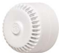
Наиболее популярная модель пожарного оповещателя может работать как в помещении, так и снаружи, под крышей и под навесом. Громкость регулируется с помощью потенциометра. Оповещатель может издавать различные сигналы в зависимости от причины тревоги. На выбор предлагается 28 предустановленных сигналов с регулируемой громкостью. Меняя полярность, можно проверять линию. В комплект оповещателя входит основание.
