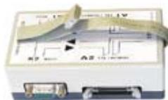
Обеспечивает интерфейс между панелью управления или рабочим терминалом и компьютером, используемым для технического обслуживания/пусконаладочных работ.
