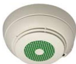
Автоматический пожарный извещатель повышенной чувствительности для использования в системах обнаружения дыма путем отбора проб воздуха. Благодаря функции автоматической адресации не нужно настраивать параметры переключателей и перфокарт. Встроенный изолятор позволяет пожарной панели управления локализовать короткие замыкания и разрывы на линии во время ввода в действие. Основание SO620A заказывается отдельно.
