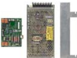
Комплект источника питания Z3I1000 используется при наличии большого числа периферийных устройств, получающих электроэнергию от панели (например, устройств, подключенных к шине LON). В случае отключения питания от Z3I1000 электроэнергия начинает поступать от встроенных батарей. В комплект входит конвертер с поддерживающей планкой и плата контроля.
