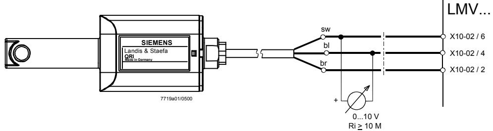
Не требуется измерение сигнала датчика с помощью вольтметра, поскольку интенсивность сигнала пламени показана на дисплее AZL... и рабочем блоке.
