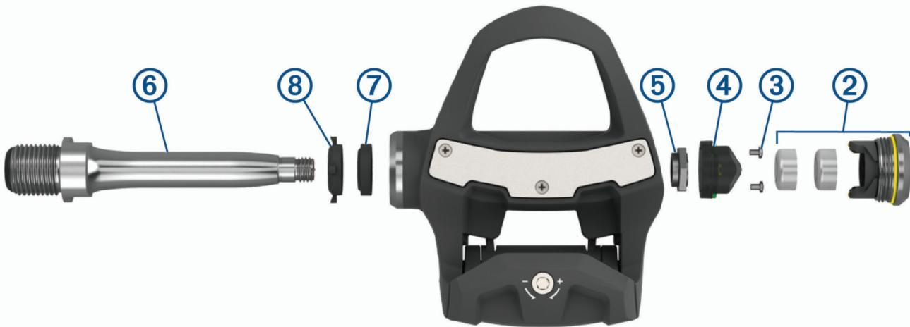
4 С помощью малой крестовой отвертки (РН 00) снимите два винта ③ с внутренней части батарейного держателя ④ .
