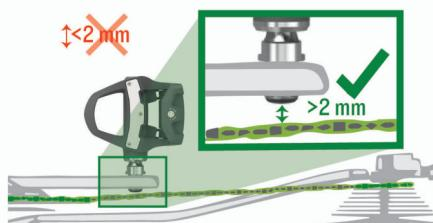
**ПРИМЕЧАНИЕ:** Компания Garmin рекомендует оставлять зазор между педалью и цепью 2 мм и более. Если педаль трется о цепь, вы можете добавить одну шайбу (в комплекте) между осью педали и шатуном для увеличения зазора. Для сохранения симметрии можно также добавить одну шайбу на ось левой педали.
