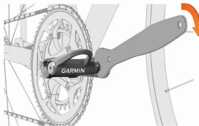
**ПРИМЕЧАНИЕ:** Компания Garmin рекомендует применять момент затяжки 25 фунт-сила на фут (34 Н·м).
