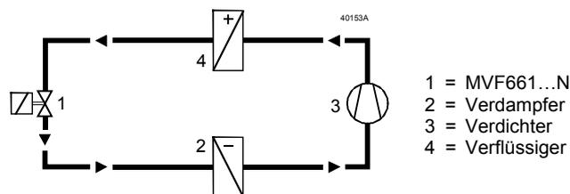
Die elektronische Überhitzungsregelung erfolgt mit zusätzlichen Regelgeräten, z.B. PolyCool.
