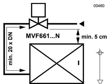
Messungen in Labors haben gezeigt, dass bessere Regelergebnisse erreicht werden, wenn das Kälteventil gegenüber dem Verdampfer höher platziert wird (min. 5 cm). Eine minimale Beruhigungsstrecke von 0,5 m oder 20 x DN sollte jedoch immer vorhanden sein.
