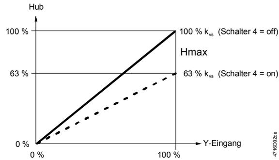
Bei eingeschalteter k<sub>vs</sub>-Reduktion (DIP-Schalter 4 in Position on) wird der Hub auf 63 % begrenzt. 63 % mechanischer Hub entsprechen dann 10 V Ein- und Ausgangssignal. Wird zusätzlich die Mindestöffnung z.B. auf 80 % eingestellt, beträgt sie  $0,63 \times 0,80 = 0,50$  des mechanischen Hubs.
