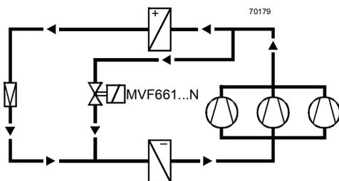
Geeignet für grosse Klimakälteanlagen, wo zwischen dem Schalten einzelner Verdichterstufen unzulässige Temperaturschwankungen auftreten können.
