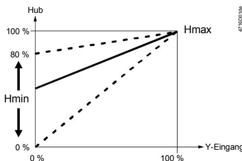
Ausreichende Kompressorkühlung und Ölrückführung kann durch ein Nachspritzventil mit Heissgasregler, eine Bypassleitung über dem Ventil oder durch eine Mindestöffnung am Saugdrosselventil bewerkstelligt werden. Die Mindestöffnung kann über den Regler und das Y-Signal oder direkt über die Ventilelektronik mit dem Potentiometer Rv vorgegeben werden.
