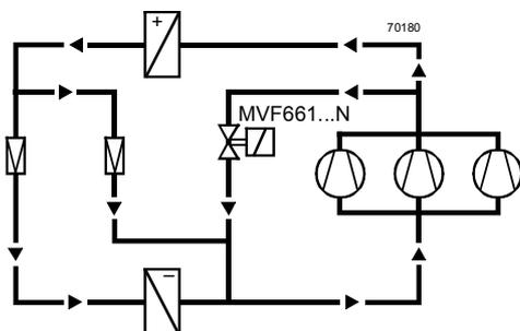
Geeignet für grössere Klimakälteanlagen mit mehreren Verdichter (-stufen) und bei grösserer Entfernung zwischen Verdampfer und Verdichter (Ölrückführung beachten).
