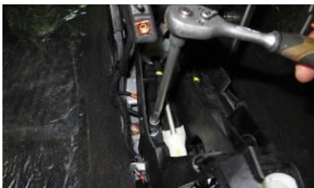
Открутите болт крепления селектора и подложите под селектор шайбу (поз. 10).
