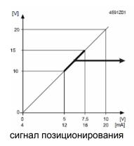
Типичный рабочий диапазон клапанов с магнитными приводами (0 ... 100% хода). Рабочий диапазон зависит от повышения температуры катушки и размера клапана. Также можно использовать электронное подключение к ZM ../ А клемме корпуса, как "прямой через" клеммы корпуса, Поставляемый непосредственно с DC 0 ... 20 V фазовый разрыв сигнала. В этом случае, 24 AC 24 V рабочее напряжение, не должно быть подключено.
