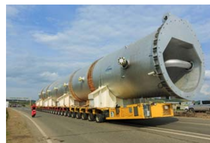
Транспортировка на Ачинский НПЗ (Россия) реактора гидрокрекинга. Вес установки - 1 300 тонн, плюс автотоповоз, который предназначен для его перевозки, - ещё полторы тысячи тонн. Это, в общей сложности, вес хорошей пятиэтажки.
