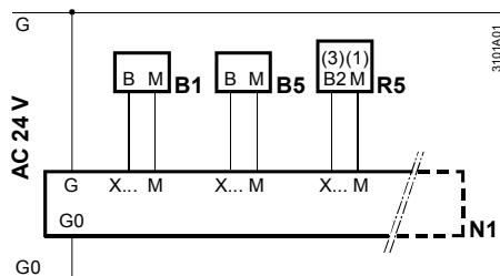
**Схема подключения 2: Часть измерительной схемы для активных датчиков**
