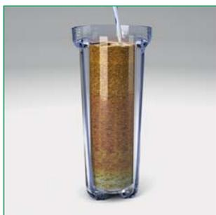
■ Установить картридж со снятой крышкой в корпус и заполнить корпус раствором соли доверху (примерно 0,5 л), осторожно заливая его через картридж и следя за тем, чтобы смола не вылилась с раствором через верх. Оставить в таком состоянии на 8–10 часов.
