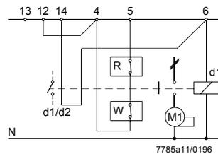
Требуемая схема подключения в случае, когда работа идет без контроля давления воздуха
