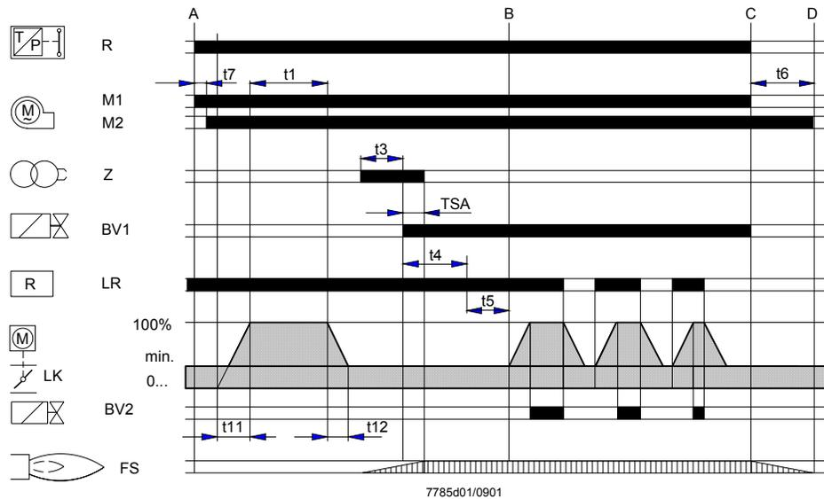
Горелки с прерывистым циклом работы (горелки с горелкой поджига), контролируются и регулируются, например, автоматами горения **LGK16.335** или **LGK16.635**.
