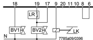
Управление приводом воздушной заслонки во время работы осуществляется путем подачи сигналов на клемму 17.
