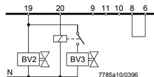
Регулирование топливного клапана при помощи клеммы 20 в случае, когда горелки не оборудованы воздушными заслонками, или же когда автоматы горения не регулируют воздушные заслонки.
