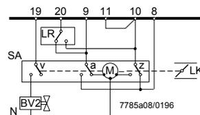
Подключение приводов воздушных заслонок без перекидного концевого выключателя для полностью закрытого положения.
