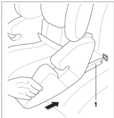
Innestare i connettori Seatfix (1) nelle stafe Isofix, in modo che sia visibile la marcatura verde sui due connettori. Controllare se sono innestati correttamente tirando il seggiolino da entrambi i lati.
