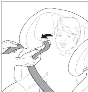
Diagonalgurt in die Gurtführung an der Kopfstütze einlegen.
