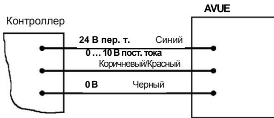
Параллельно может быть подключено до 10 приводов AVUE. Убедитесь, что номинальные характеристики источника питания 24 В переменного тока соответствуют числу подключенных приводов AVUE.
