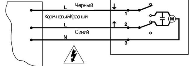
Термостатирующее реле или другое коммутационное устройство
