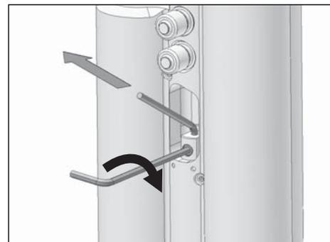
6. Натяните трос и затяните его винтом крепления троса (S10), используя шестигранный ключ 2 мм.
