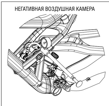
SCOTT настоятельно рекомендует устанавливать давление в положительной и отрицательной камере в соответствии с инструкциями данного руководства по эксплуатации. Несоблюдение данных рекомендаций может послужить причиной аварии или поломки амортизатора.
