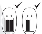
**3** Время заряда составляет около 13 часов для аккумуляторов типоразмера AA (1500mAh) и около 5 часов для аккумуляторов типоразмера AAA (600mAh). Время зарядки аккумуляторов зависит от уровня остаточного заряда батарей, условий процесса зарядки от сети. Точная информация о времени зарядки аккумуляторов различной емкости указана в данном руководстве. Извлекайте элементы питания после зарядки.
