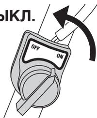
Чтобы остановить двигатель в аварийной ситуации, переведите рычаг останова двигателя на выключателе в положение OFF («выключено»).
