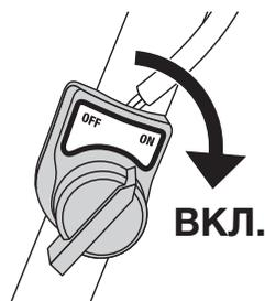
Переведите рычаг останова двигателя на выключателе в положение ON («включено»).
