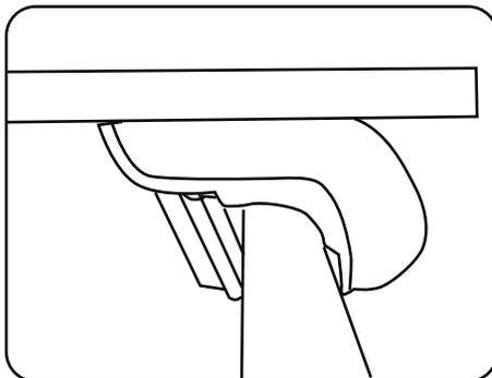
2. Для фиксации местоположения опор на дугах, с помощью Г-образного ключа из комплекта подтяните винты опор.
