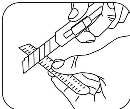
5. Вставьте отрезанную часть линейки в паз до упора. Поставьте на дугу опору. Прodelайте то же самое с остальными опорами.
