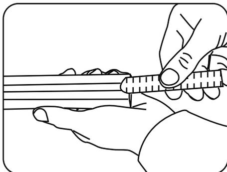
6. Вставьте в пазы дуг пластиковые линейки и отрежьте их с таким расчетом, чтобы оставался свободным паз глубиной 1,5 см.
