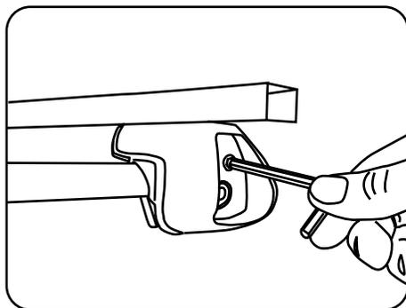
3. Сделайте отметки на дугах по линии окончания резиновых подушек опор. Ослабьте винты и снимите опоры с дуг. Замерьте глубину пазов до отметок (S).
