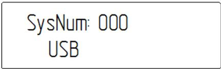
Адрес устройства задается с помощью цифровых клавиш. Адрес должен быть в диапазоне от 0 до 254, в случае неверного ввода адреса, выход из режима редактирования будет невозможен.
