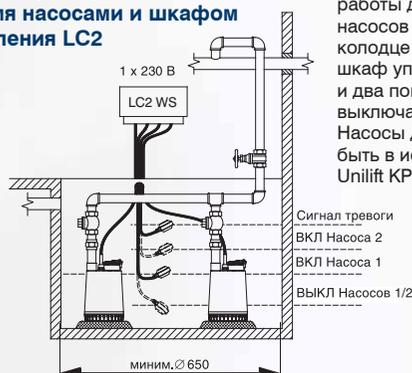
Внимание! Для работы двух насосов в одном колодце требуются шкаф управления и два поплавковых выключателя SAS. Насосы должны быть в исполнении Unilift KP ... M1
