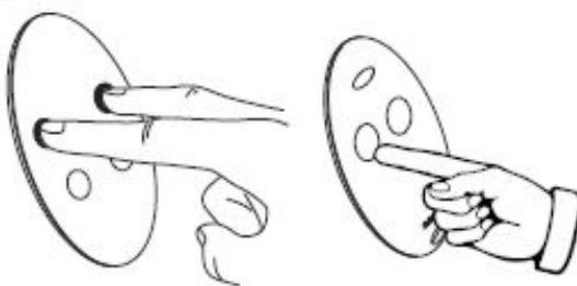
7. После записи всех необходимых брелков в память радиоприемника нажать одновременно кнопки <+> и <-> два раза.
