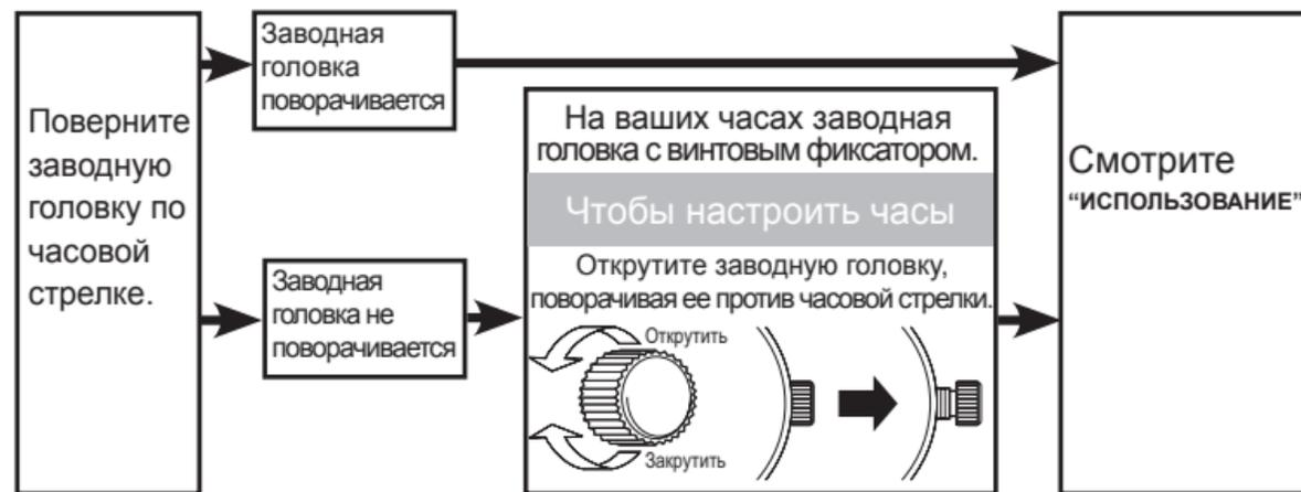
\* Если у ваших часов заводная головка с винтовым фиксатором, то она ввинчена в корпус часов для дополнительного предохранения.
