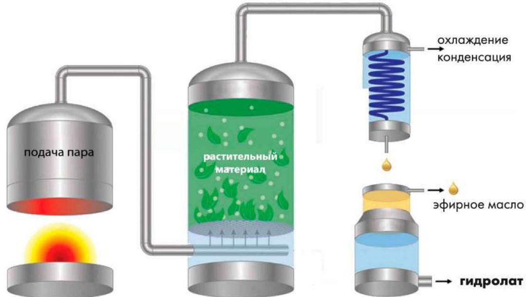
Способ производства настоящего чистого эфирного масла - это паровая дистилляция. Пар проходит через растения, насыщается душистыми компонентами, при охлаждении конденсируется, разделяясь в итоге на эфирное масло и ароматную жидкость - гидролат.
