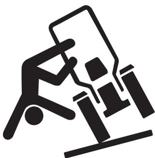
Всегда используйте ремень безопасности и убедитесь, чтобы конструкция защиты кабины была правильно установлена. Избегайте ям, канав и преград, которые могут привести к наклону или опрокидыванию трактора, особенно на склонах гор. Избегайте резких поворотов, а также поворотов на подъеме.
