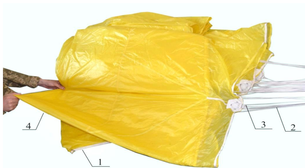
1- кромки трех левых воздухозаборников; 2- стропы первого ряда; 3- стропы второго ряда; 4- полотнища между стропами первого и второго ряда
