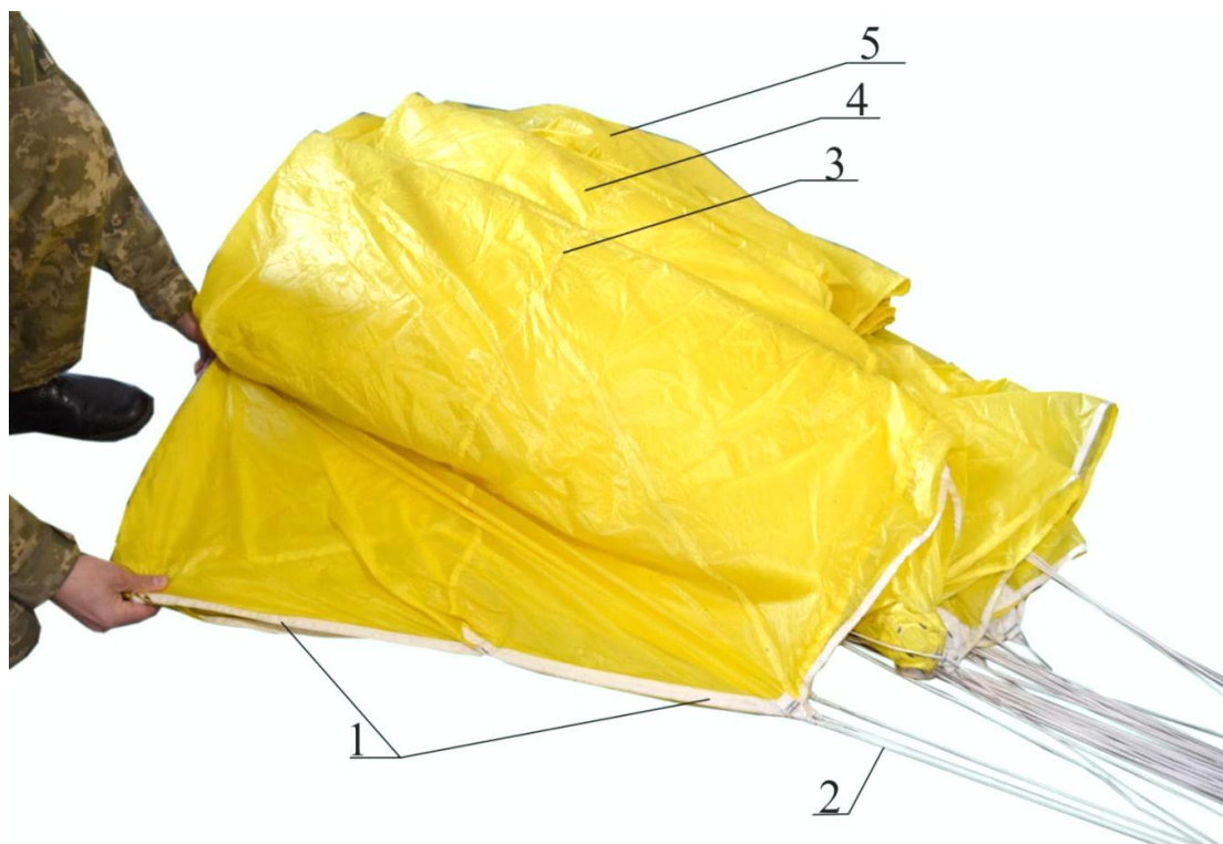
1- кромки трех воздухозаборников; 2- стропы первого ряда; 3- первое сложение купола; 4- второе сложение купола; 5- третье сложение купола
