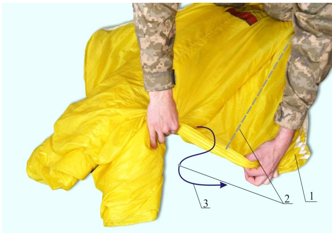
1- воздухозаборники купола; 2- линия сгиба воздухозаборников; 3- схема сложения воздухозаборников
