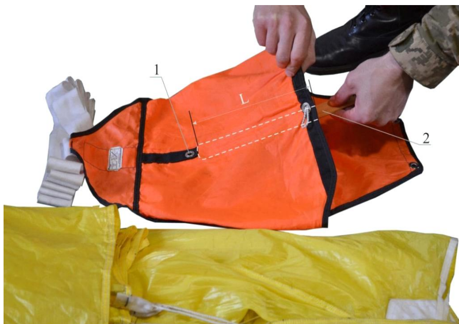
1- люверс зачековки; 2- укладочная линейка; L- измеряемая длина
