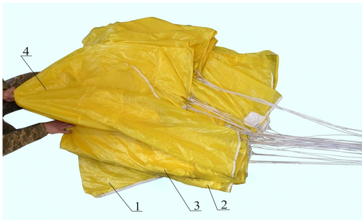
1- кромки трех воздухозаборников; 2- первое сложение купола; 3- второе сложение купола; 4- третье сложение купола
