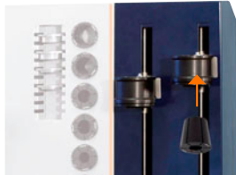
Fig. 11: Inserimento dell'inserto di raffreddamento in un raffreddamento a contatto libero.
