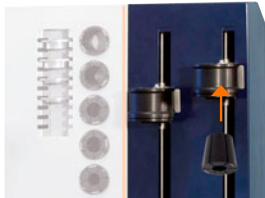
Fig. 11: Colocación del inserto de refrigeración en un refrigerador de contacto libre.
