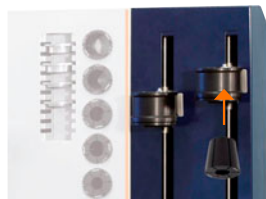
Obr. 11: Vložení chladicí vložky do volného kontaktního chladiče.
