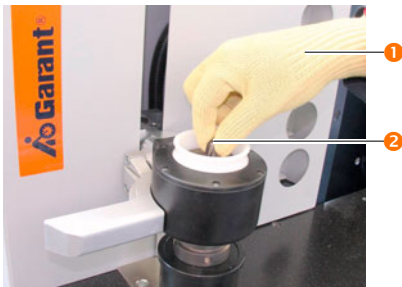
Abb. 10: Beim Schrumpfprozess Werkzeug mit Handschuh halten.
