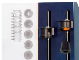
Рис. 11: Установка охлаждающей втулки в свободную водо-охлаждаемую гильзу
