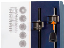
Ilustr. 11: Wkładanie wkładki chłodzącej w wolny moduł chłodzenia kontaktowego.
