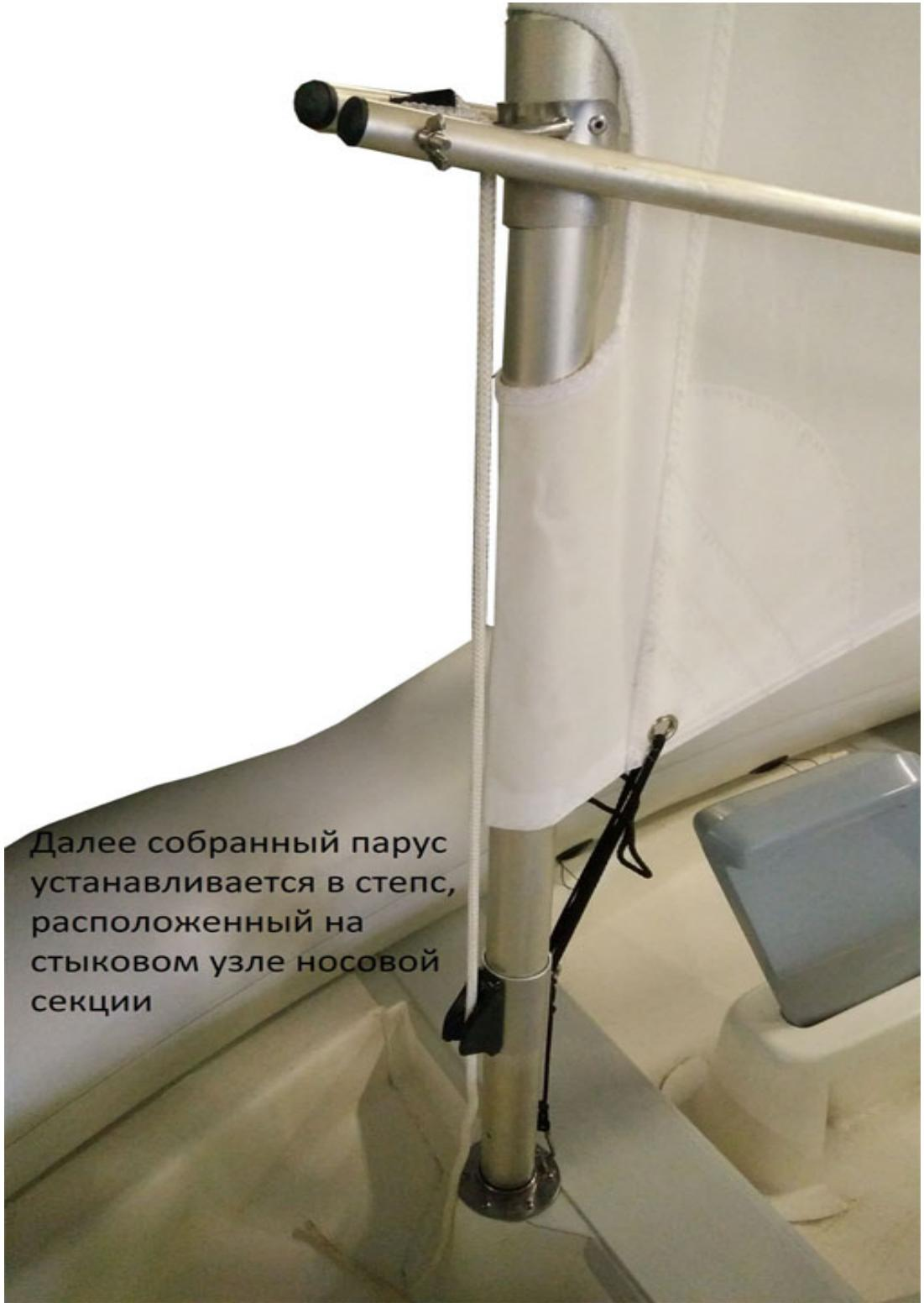
Далее собранный парус устанавливается в стекл, расположенный на стыковом узле носовой секции
