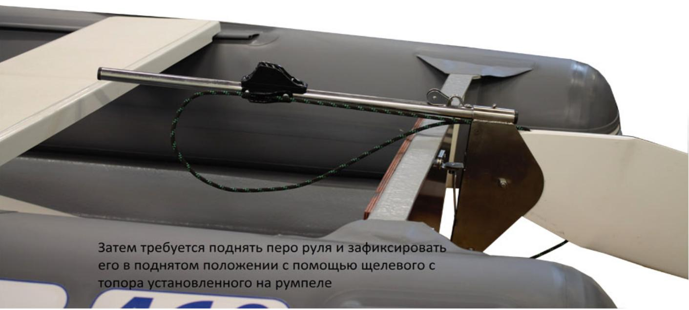
Затем требуется поднять перо руля и зафиксировать его в поднятом положении с помощью щелевого стопора установленного на румпеле
