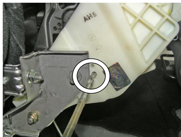
Расширить технологическое отверстие в стенке селектора
