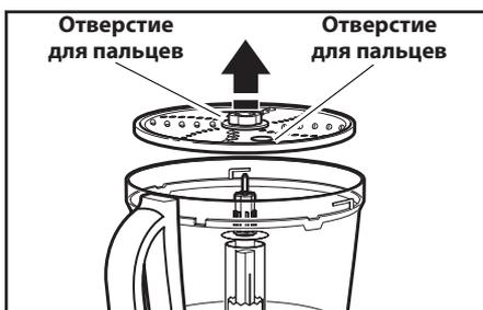
**4** Если вы использовали режущий диск, выньте его. Для этого удерживайте диск при помощи 2-х отверстий для пальцев и поднимайте его вверх.
