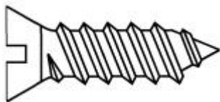
Рисунок 1 - Самонарезающий формирующий винт (3.6.10) Рисунок 2 - Самонарезающий режущий винт (3.6.11)
