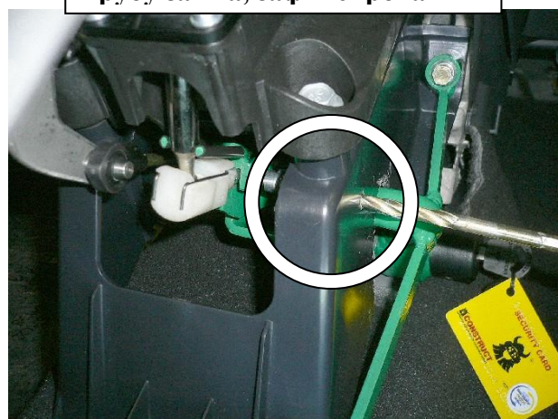
Просверлить технологическое отверстие в селекторе
