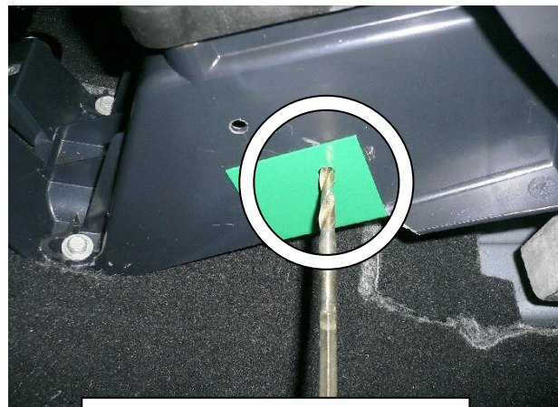
Просверлить отверстие в селекторе под трубу замка
