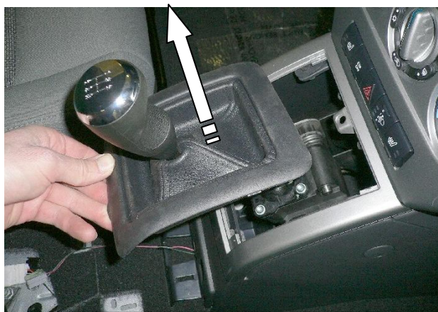
Снять декоративный чехол рычага переключения передач
