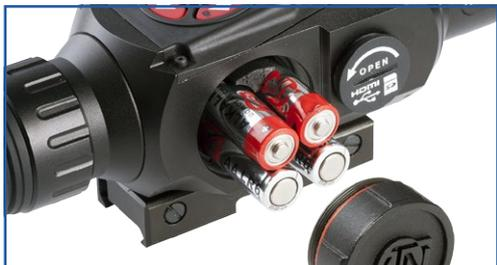
Используйте 4 литиевые батарейки типа AA, убедившись, что крышка плотно закручена. Затяните крышку так, чтобы не было видно красного уплотнительного кольца. Слабо затянутая крышка может стать причиной отключения прибора во время отдачи!
