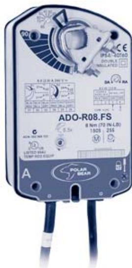
Электрические привода Polar Bear разработаны специально для использования с воздушными заслонками в системах вентиляции и кондиционирования. В каждый привод встроена система «Safety» с возвратной пружиной, обеспечивающая при аварийном отключении напряжения полное закрытие воздушной заслонки для предотвращения размораживания водяных теплообменников.
