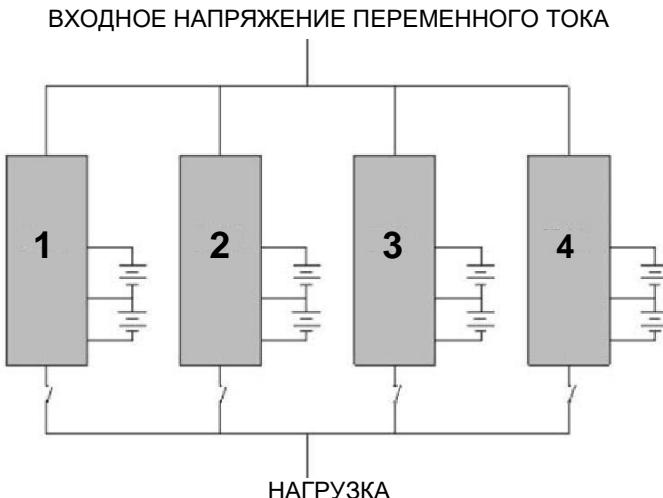
Рисунок 25 - Схема подключения изделий в систему параллельного резервирования
