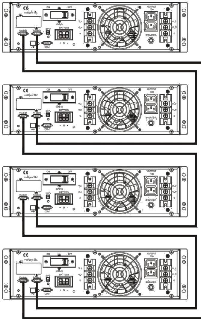
Рисунок 26 - Объединение изделий в систему параллельного резервирования
