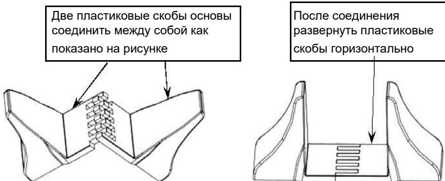
Рисунок 23 - Сборка пластиковых основ для вертикальной установки изделия
