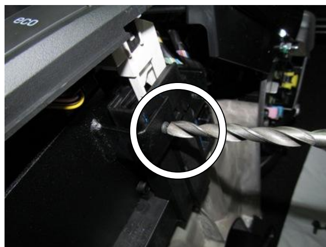
Рассверлить шлиц самореза, сделав его неизвлекаемым
