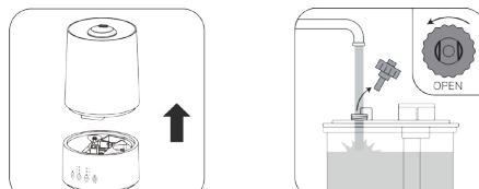
Переверните бачок и вставьте его обратно в прибор таким образом, чтобы он зафиксировался с характерным щелчком. Убедитесь в том, что водяная ванна пустая. После окончания использования вылейте остатки воды и промойте бачок свежей питьевой водой. Перед повторным использованием заполните бачок свежей питьевой водой. Если Вы предполагаете, что не будете длительное время пользоваться прибором, выньте бачок из прибора и опорожните его.
