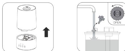
Vidalı kapağı takarak su haznesini tekrar kapatın ②. Su Küveti 'in boş olduğundan emin olun. Cihazı su haznesi dolu durumda taşımayın. Kullandıktan sonra içinde kalan suyu boşaltın ve hazneyi temiz içme suyu ile yıkayın. Tekrar kullanmadan önce hazneye taze içme suyu doldurunuz. Cihazı kapatıp uzun bir süre kullanmayacaksanız, su haznesini cihazdan çıkartın ve içini boşaltın.
