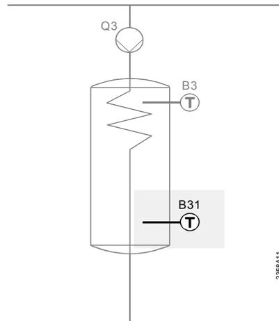
**Бак ГВС с внешним теплообменником, загрузочным насосом и насосом промежуточного контура**
