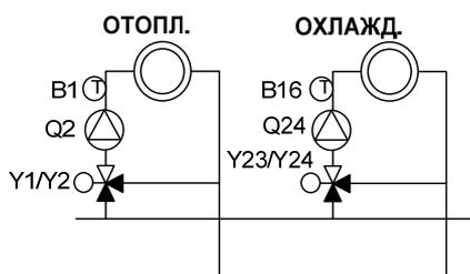
Контурь охлаждения и отопления отбирают энергию (холод или тепло) от единого основного контура.
