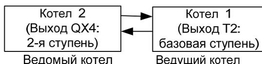
При включении режима автоматической смены очередности работы, «котел 1» (подключенный к выходу контроллера T2) всегда стартует как ведущий.
