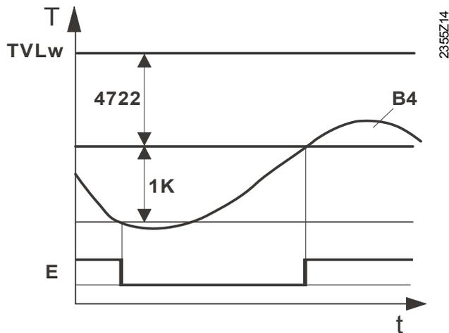
Парметр 4722 Температурная разница Буфер / Контур отопления
