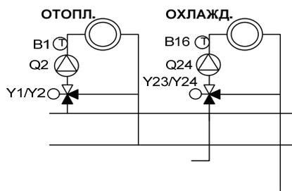
Контурь охлаждения и отопления отбирают энергию (холод или тепло) от разных главных контуров.
