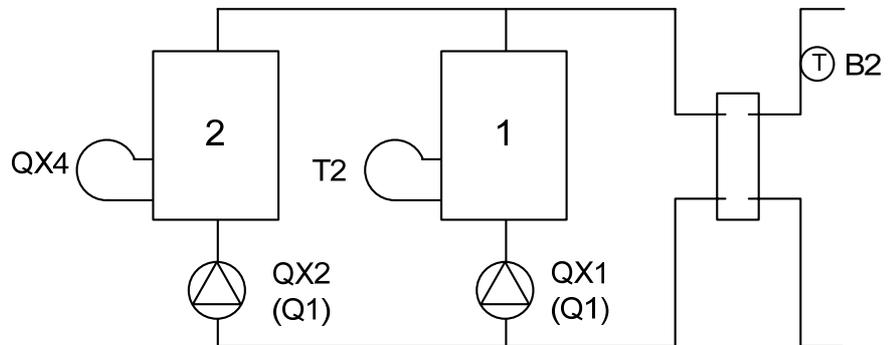
Благодаря температурной разнице (дифференциалу) между уставкой котла и датчиком котла B2 (обязательный при каскадной работе датчик температуры общей линии подачи), операции вкл. / выкл. ведомого котла (рассчитываемые соответственно по интегралам включения и выключения) выполняются аналогично алгоритму управления 2-ступенчатой горелкой. Т.е. используются те же самые параметры.
