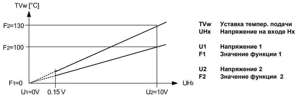
Если величина сигнала на входе H... падает ниже минимально допустимой границы 0.15В, то внешний запрос на генерацию требуемого количества тепла / холода не имеет силы и игнорируется тепло- или хладогенератором.
