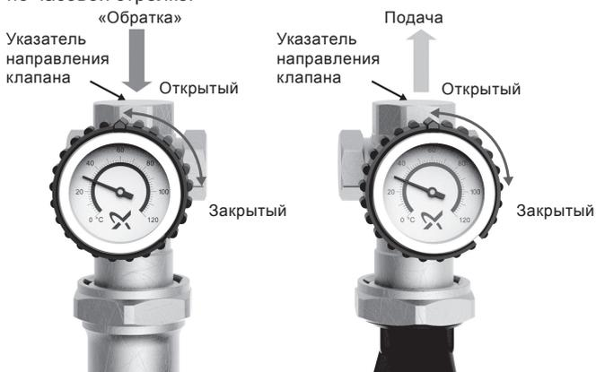
*Шаровый кран с синей шкалой на стороне обратного потока имеет внутренний обратный клапан. Если шаровый кран только частично открыт/закрыт, то обратный клапан будет оставаться частично открытым.*
