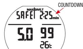
La parada se señala en la pantalla con el icono SAFE y una clara indicación de la duración en minutos y segundos con una cuenta atrás. La parada de seguridad no es obligatoria pero se recomienda encarecidamente en caso de que, por ejemplo, se supere repetidamente la velocidad máxima de ascenso. Cressi recomienda respetarla siempre para no incurrir en problemas de seguridad.
