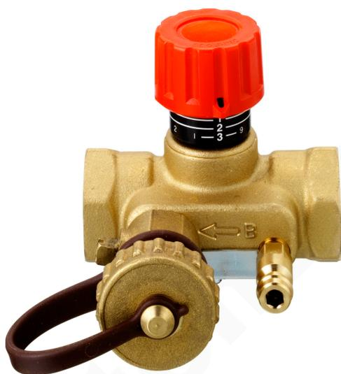
Клапан балансировочный типа MNT (далее – клапан типа MNT) служит для: перекрытия потока перемещаемой по трубопроводу среды, ограничения максимального расхода теплоносителя, проходящего через регулируемый участок системы, путем изменения пропускной способности клапана за счет ограничения степени его открытия (величины подъема штока), измерения количества теплоносителя, протекающего через данный участок системы, и слив жидкости.
