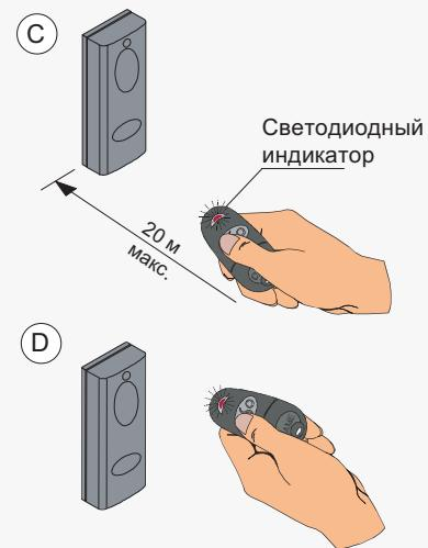
**ВНИМАНИЕ!** Каждое последующее нажатие кнопки (при программировании нескольких брелков-передатчиков) должно производится в течение интервала времени не более 20 секунд после предыдущего, иначе процедура программирования прерывается.
