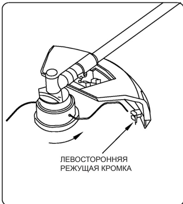
При использовании режущей головки обязательно устанавливайте мусороотражающий щиток. Если нейлоновая нить излишне вытянута, она может отвиснуть. Всегда устанавливайте мусороотражающий щиток при работе с режущей головкой.
