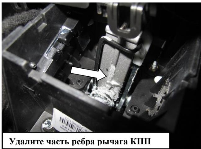
Удалите часть ребра рычага КПП
