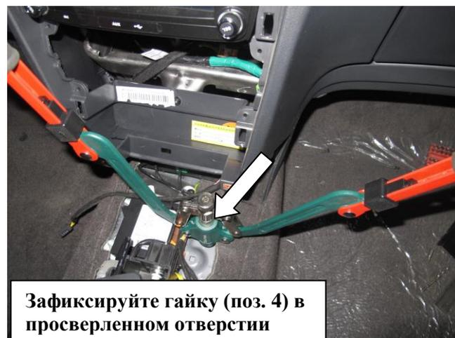
Зафиксируйте гайку (поз. 4) в просверленном отверстии
