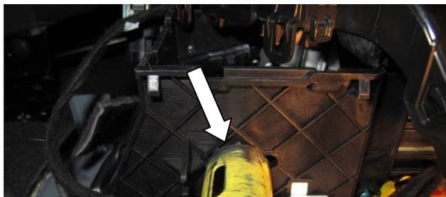
Приложите замок (поз. 1) по задней точке крепления. Отметьте место касания пластика селектора и замка (поз.1). Снимите замок (поз.1) и просверлите отверстие в стенке селектора Ø22 мм.
