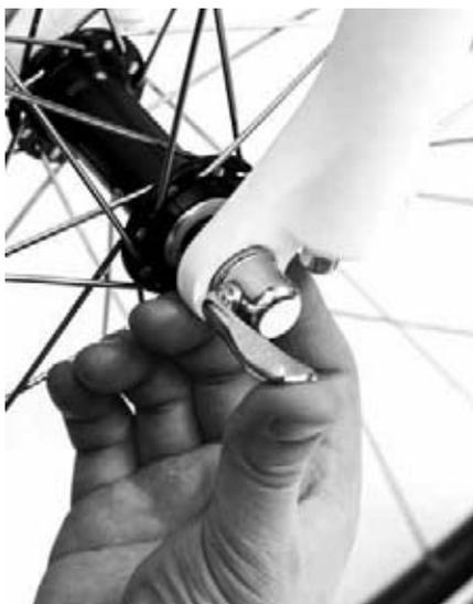
*Закрутите по часовой стрелке гайку на обратной стороне втулки до тех пор, пока не начнет сопротивляться вращению. Не пытайтесь преодолеть сопротивление гайки и закручивайте ее только руками, без применения какого-либо инструмента!*
