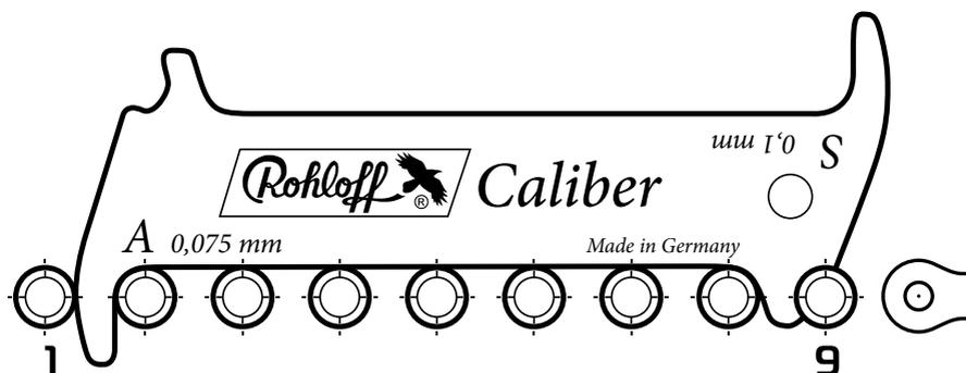
Рисунок 7. Цепной калибр позволяет предупредить начало износа трансмиссии из-за слишком сильно изношенной цепи
