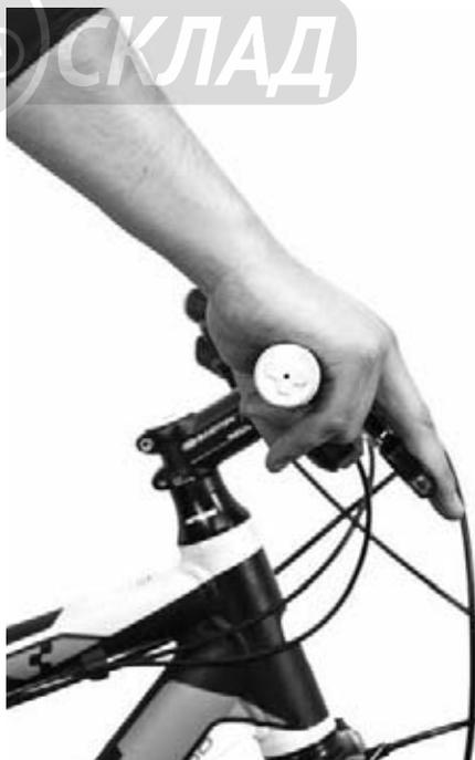
3. Вынос руля должен быть установлен на такой высоте, чтобы препятствовать касанию руля верхней трубы велосипеда при повороте переднего колеса на любой угол.
