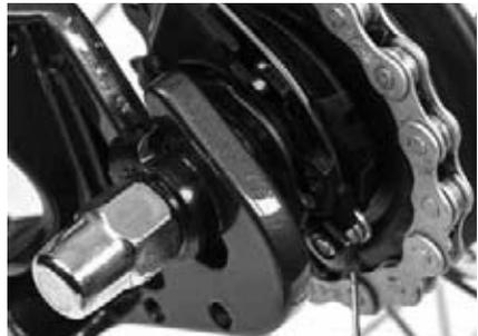
**Рисунок 25. Регулировка натяжения тросика переключающей планетарной втулки.**
