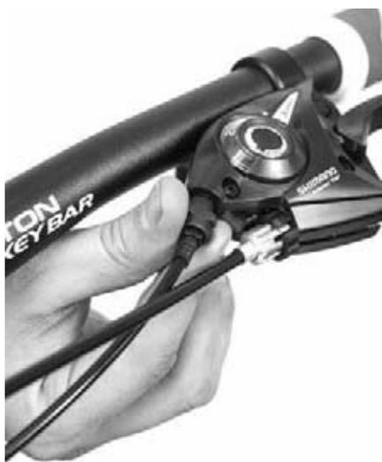
Если вы заметили, что какой-либо из переключателей «недобрасывает» цепь на большую звезду, следует немного увеличить натяжение тросика: вращайте соответствующую гайку на корпусе манетки (шифтера) против часовой стрелки (см. рис. 24). Если же, наоборот, переключатель плохо сбрасывает цепь на меньшую звезду, то вращать гайку шифтера следует по часовой стрелке.
