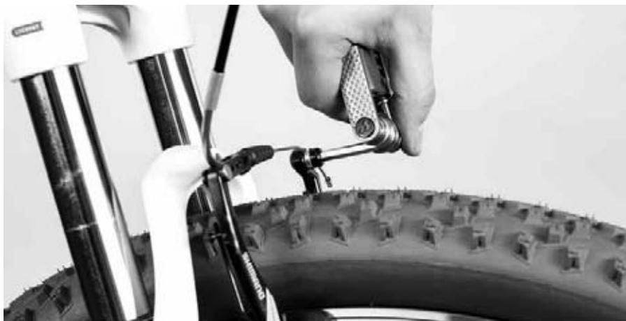
*Рисунок 18. Затяжка тормозного тросика на тормозах типа V-brake*
