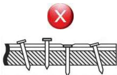
Рис. 3 Пример неправильной забивки гвоздей при монтаже продукции.
