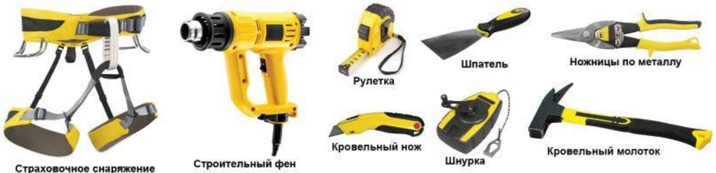
Рис. 1 Перечень инструментов кровельщика.
