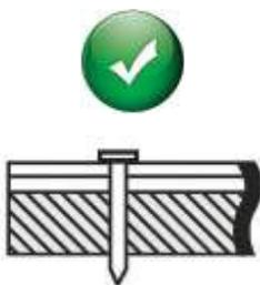
Рис. 2 Пример правильной забивки гвоздей при монтаже продукции.
